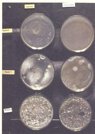
Рис. 33. Уменьшение численности микроскопических грибов и других микроорганизмов в зависимости от высоты отбора пробы (северная сторона северо-восточного столба). Чашки, засеянные пробами деструктированного камня. Нижний ряд 10 см, второй ряд 50-60 см, третий ряд 110-120 см от уровня пола. Слева среда Чапека с крахмалом, справа среда Чапека, на седьмой день роста.
