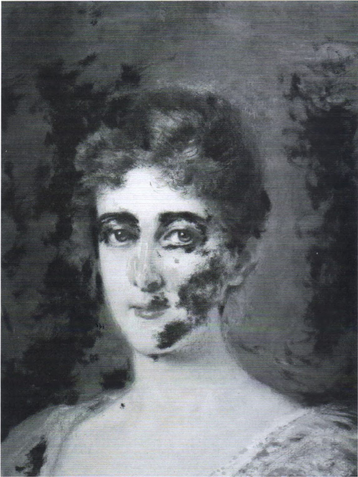
Ил. 46. К. Маковский. Женский портрет. Фрагмент. Люминесцентная фотография. В виде темных пятен видны участки поверхности свинцовых белил, пройденные цинковыми белилами
