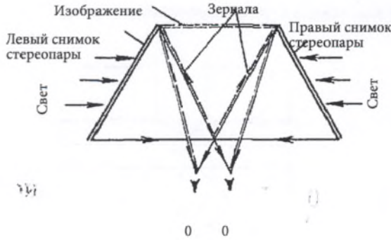
Ил. 18. Типовые схемы стереонегатоскопов для рассматривания рентгеновской стереопары: а – стереоскоп Уитстона; б – стереоскоп с угловой регулировкой
