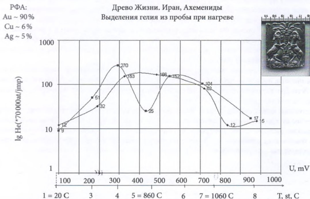
Ил. 57. Десорбция гелия при нагревании пробы золота Ахеменидской бляшки (цветное воспроизведение см. на с. VII цветной вклейки)
