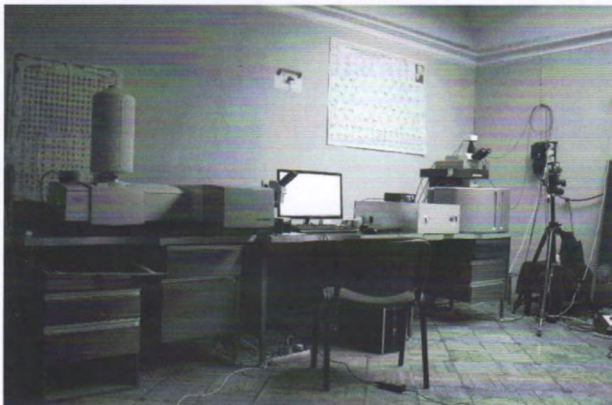
Ил. 52б. Рамановский комплекс Bruker в Эрмитаже (микроскоп Sentera + Раман-Фурье спектрометр MultiRam), оснащенный 3 лазерами, генерирующими соответственно длины волн 532 нм, 785 нм и 1064 нм
