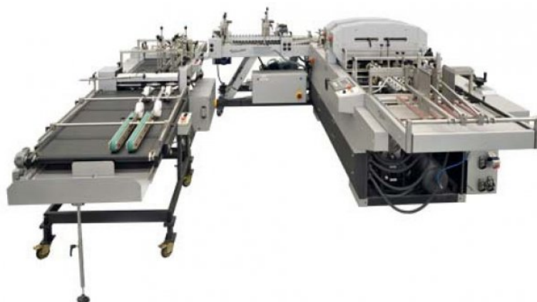
Рис. 5.8. Фальцевально-склеивающая линия «FidiaTellus», специально разработанная для производства интегральных обложек
