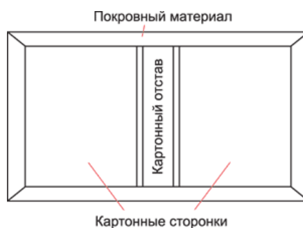
Рис. 5.1. Конструкция стандартной переплетной крышки
