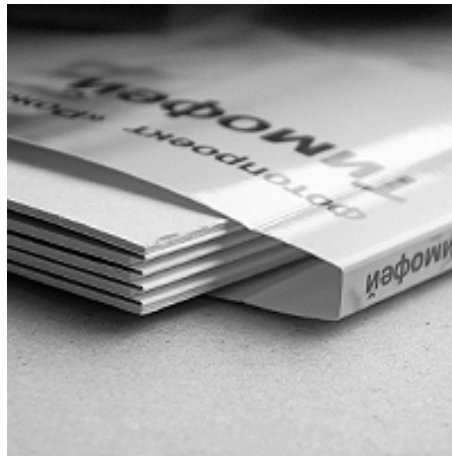
Рис. 6.30. Крытье книжного блока мягкой обложкой
