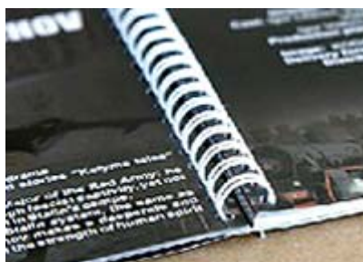
Рис. 1.5. Переплет двойной проволочной петлей “Ware-O”
