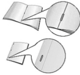
Рис. 1.10. Переплет на основе шитья втачку и внакидку
