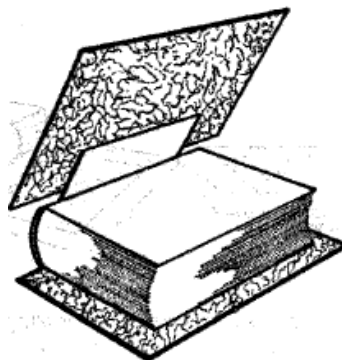
Рис. 7.29. Наклейка картонной сторонки на слезуру
