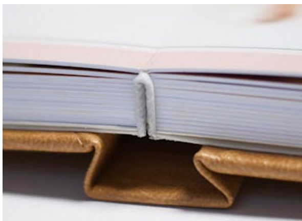
Рис. 6.21. Вид скрепления разворотов по технологии “ Butterfly ”
