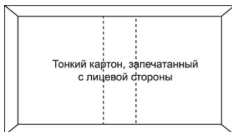
Рис. 5.2. Конструкция интегральной переплетной крышки
