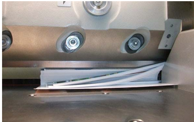
Рис. 6.27. Обрезка книжного блока
