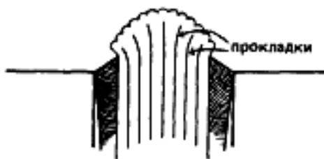
Рис. 7.18. Высота отгибки фальцев для книги в жестком переплете
