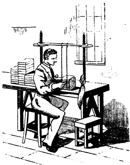
Рис. 70-й. Положеніе станка и работника при сшиваніи.
