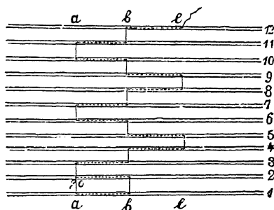
Рис. 57-й. Сшиваніе тетрадей въ три прокола—обыкновенный способъ. Цифры—тетради по порядку сшиванія. Точечныя линіи—ходъ нитки внутри тетрадей.
